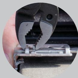
Setzen Sie die Zange am Bügel und Haken an.
